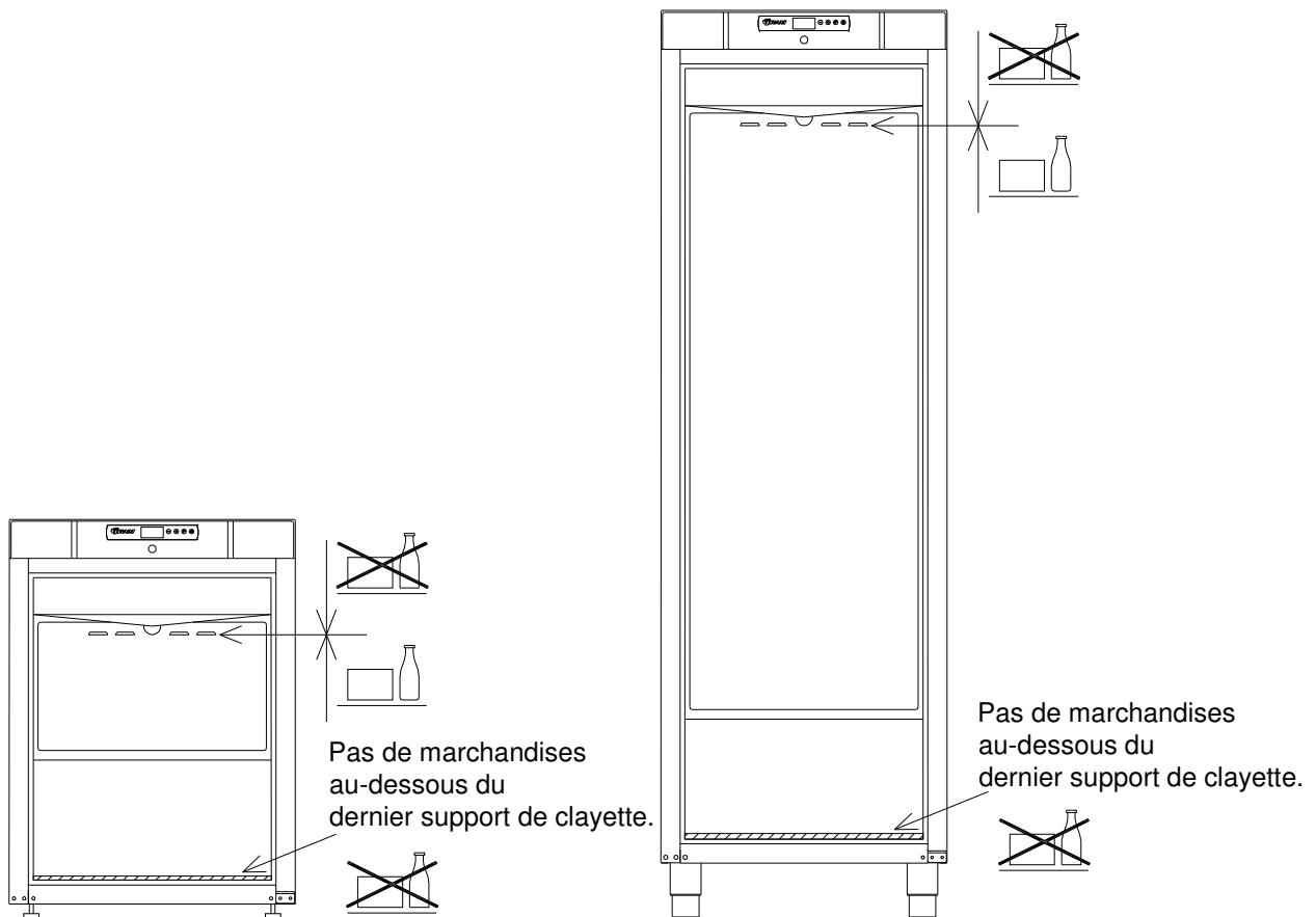
Tous les produits alimentaires qui ne sont pas emballés et qui doivent être conservés dans l'appareil, doivent être couverts pour prévenir toute corrosion inutile des éléments intérieurs, entre autres de l'évaporateur.
