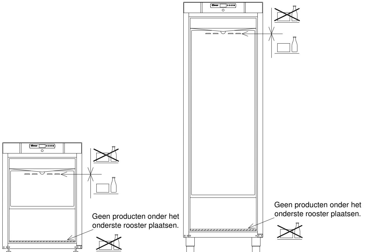
Dek alle levensmiddelen die niet bij voorbaat verpakt zijn en die in de kast moeten worden bewaard, goed af om onnodige corrosie van de delen in de kast zelf te vermijden, hieronder de verdamper.
