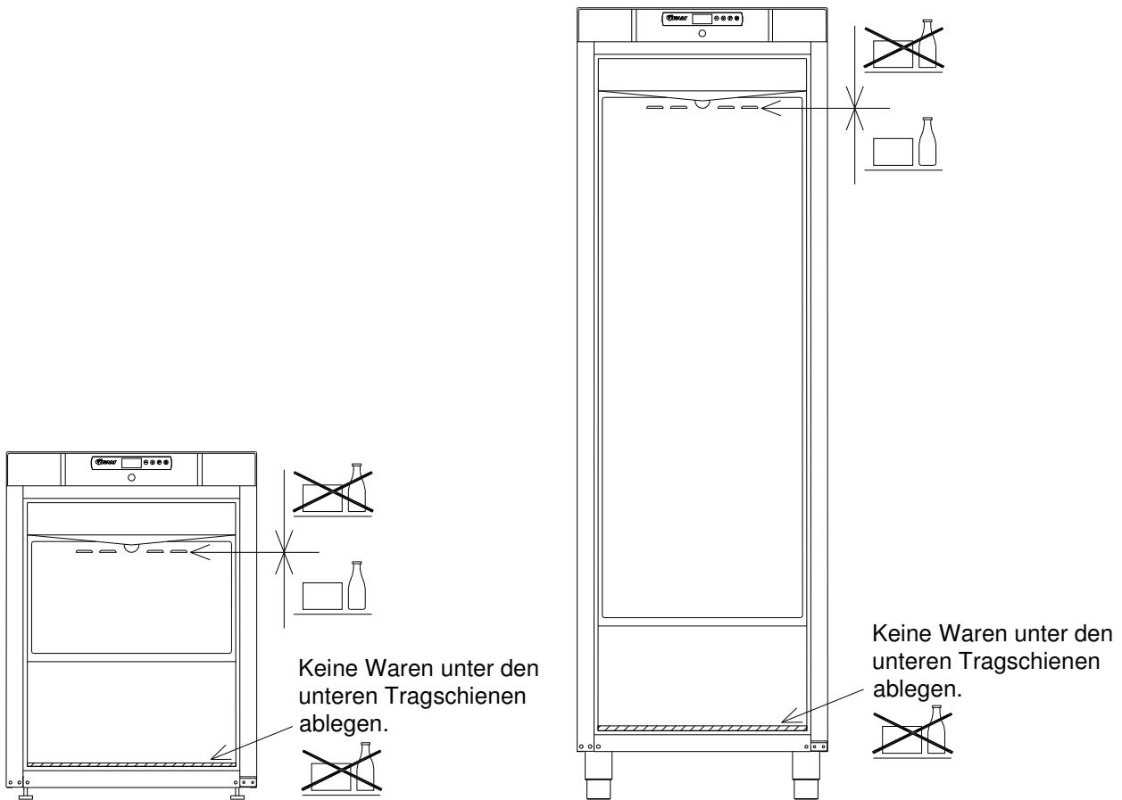
Alle unverpackten Lebensmittel, die im Schrank gelagert werden sollen, sind zu bedecken, um unnötige Korrosion des Schrankinnern, u.a. des Verdampfers, zu vermeiden.
