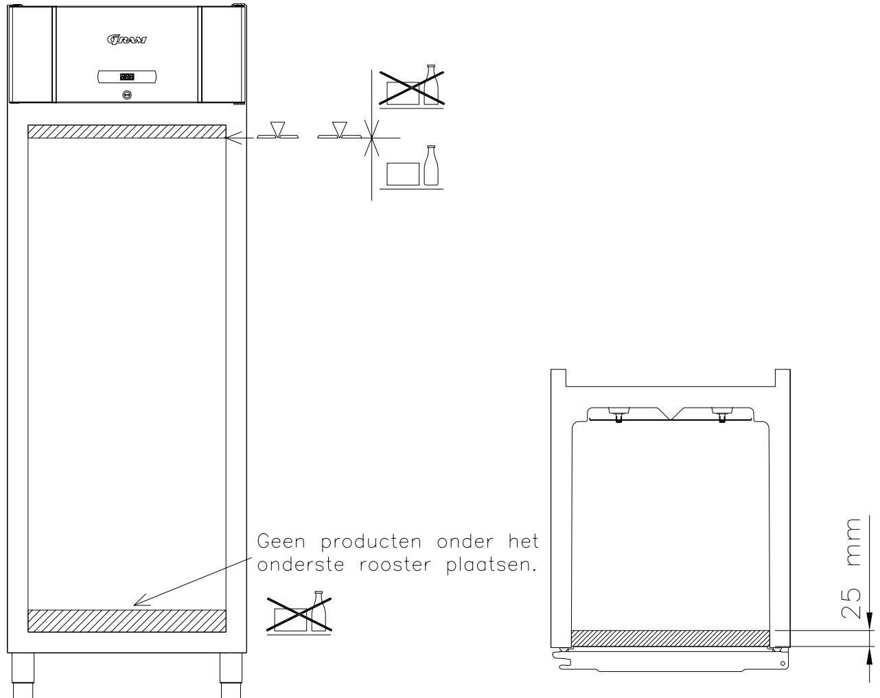
Dek alle levensmiddelen die niet bij voorbaat verpakt zijn en die in de kast moeten worden bewaard, goed af om onnodige corrosie van de delen in de kast zelf te vermijden, hieronder de verdamper.
